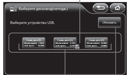
Показывает подсоединенный в настоящий момент носитель для сохранения изображений, а также общий объем и свободное пространство каждого носителя для сохранения изображений.
